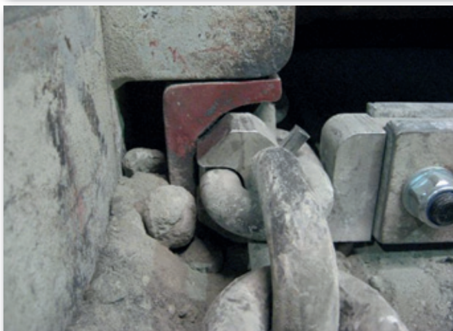
Uniwersalne uchwyty umożliwiają wykorzystanie posiadanych zgrzebel i zastosowanie łańcuchów w długich odcinkach
