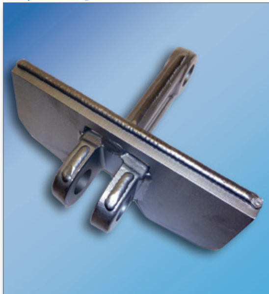
Nanoszenie twardej napoiwy w miejscach szczególnie narażonych na wytarcie znacząco wydłuża żywotność zgrzebel
